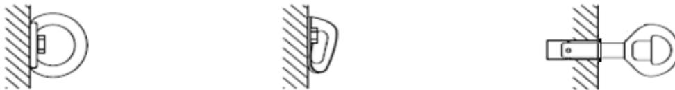
Anschlageinrichtungen (AE), die, wenn sie montiert sind, einen oder mehrere ortsfeste(n) Anschlagpunkt(e) enthält und für deren Befestigung an der baulichen Einrichtung (ein) baulich verankerte(s) Befestigungsmittel oder (ein) Befestigungselement(e) erforderlich ist/sind.
