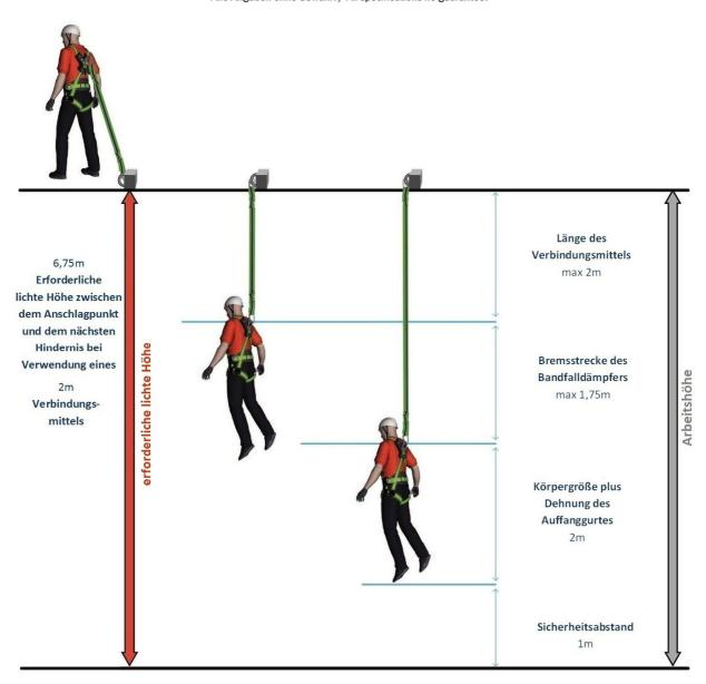
Dieses Beispiel zeigt Ihnen, wie die erforderliche lichte Höhe zwischen dem Anschlagpunkt und dem nächsten Hindernis/Boden berechnet wird, wenn sich der Anschlagpunkt auf Fußhöhe des Arbeiters befindet.
