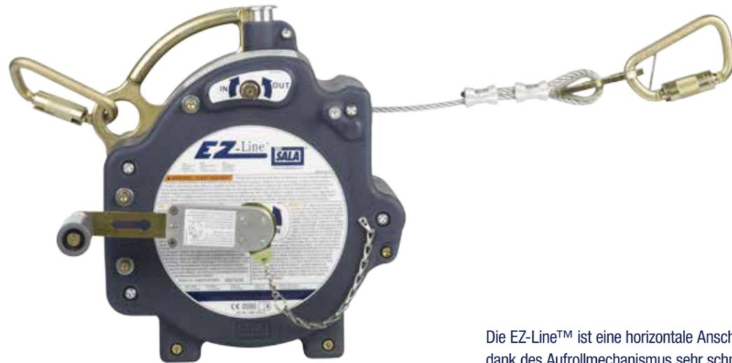
Die EZ-Line™ ist eine horizontale Anschlageinrichtung, die sich dank des Aufrollmechanismus sehr schnell installieren lässt. Das Gerät hat einen Tragegriff für den Transport, einen Sturzindikator und eine Spannvorrichtung mittels Kurbel. Zugelassen für 2 Personen. Anwendergewicht max. 140 kg.
