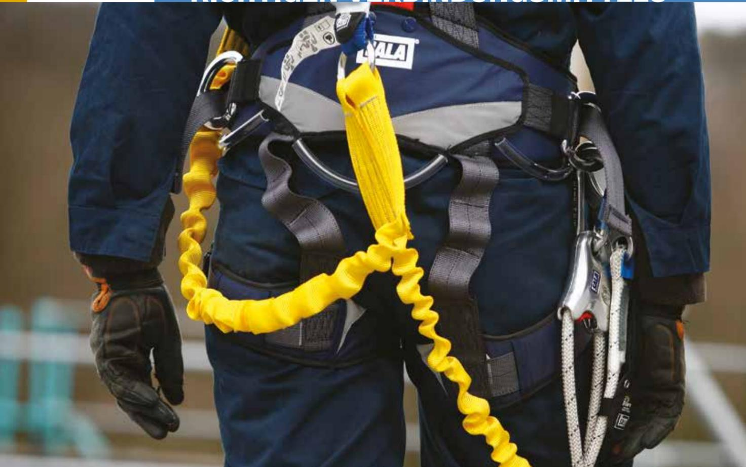
Verbindungsmittel werden in 3 unterschiedliche Arten eingeteilt, von denen jedes einen bestimmten Zweck erfüllt: Schockabsorbierende Verbindungsmittel (mit Absorber), Rückhalteverbindungsmittel (ohne Absorber) und Arbeitspositionierungs-Verbindungsmittel.
